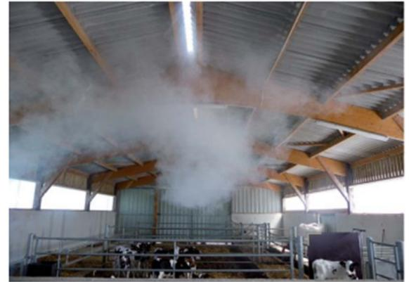
Observation du circuit d'air par fumigène
